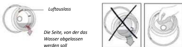
Den Wasserbehälter, eventuell freiliegende Keramikscheiben und die Außenseite des Behälters mit Alkohol reinigen. Keine Reinigungsmittel verwenden.
